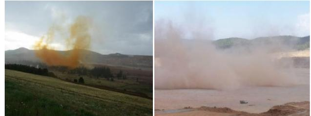
Figure 1 (L-R) Baseline blast fumes vs. TITAN  $\Delta E$  blast fumes
