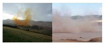
Figure 1 (L-R) Baseline blast fumes vs. TITAN  $\Delta E$  blast fumes
